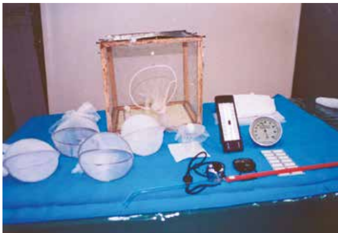
Figura An7.7 Conteúdos do kit de teste que usa o aparelho de rede com armação de arame
