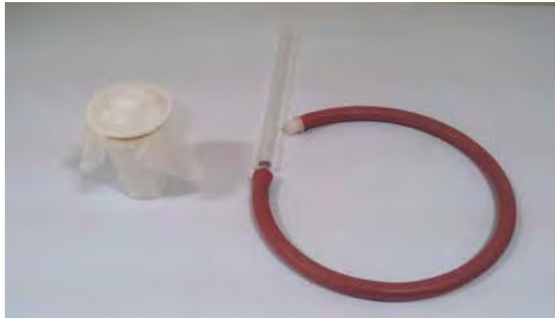
Figura 3.1 Tubo de sucção (ou aspirador) e copo de papel para a colheita manual de mosquitos adultos
