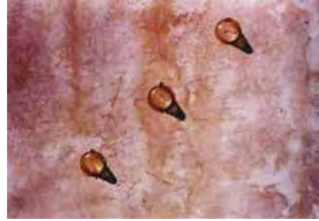
Figura An6.1 Câmaras de exposição presas em diferentes partes da superfície da parede
