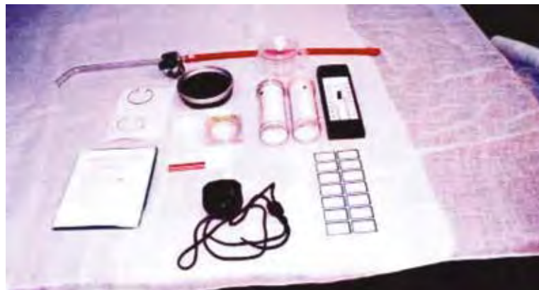
Figura An4.1 Equipamento para o teste de suscetibilidade com uma caixa de papel impregnado com insecticida
